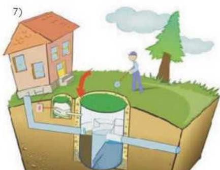
Po napuštění vodou obsypejte ČOV pískem, popř. tříděnou zeminou,
